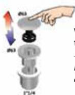
Wastafel wordt geleverd incl. afvoerplug type LIG1020, zie p. 33
