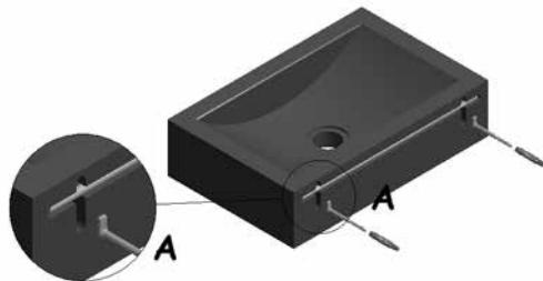
Kan toegepast worden bij alle wastafels met een diepte van max 350 mm en hoogte  $\geq$  8cm.
